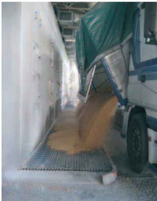
Modalità di scarico in tramoggia a pavimento (foto illustrativa)
